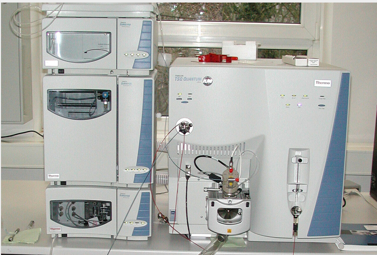
TSQ Quantum Ultra AM (Finnigan, Triple Quadrupole MS) mit UHPLC (Accela 12
