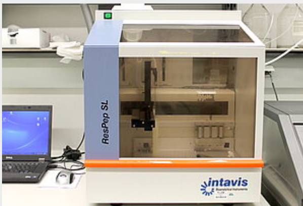
Intavis ResPep SL automatisierter Tisch-Peptid-Synthesizer
