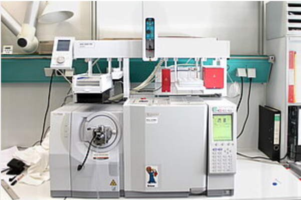
GC/MS-System (Shimadzu) mit Autosampler AOC 5000, Headspace, SPME und Direkteinlasssystem
