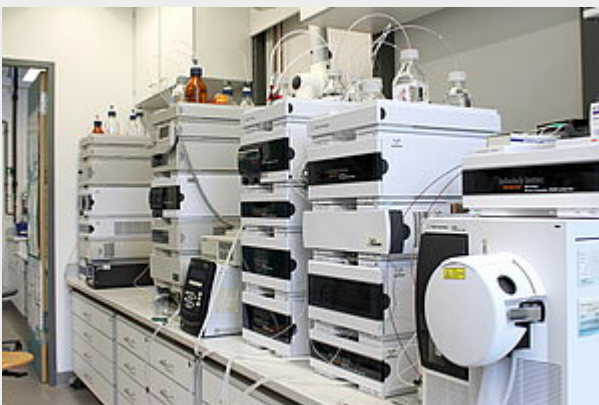
Agilent Infinity Series 1260 Systeme mit DAD, FLD, MWD sowie Fraktionensammlern
