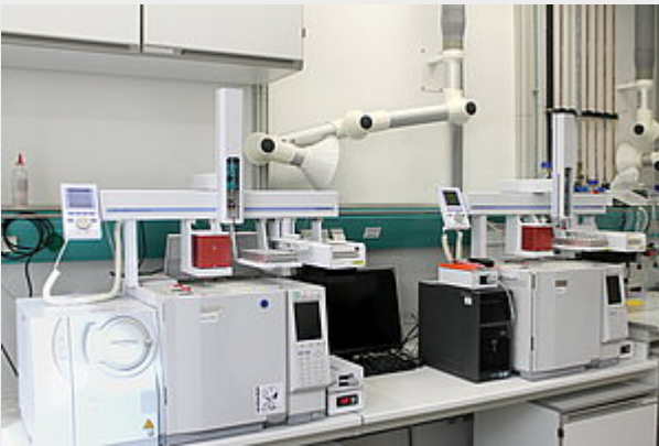
GC/MS-System (Shimadzu) mit Autosamplern AOC500 und integrierter Headspace
